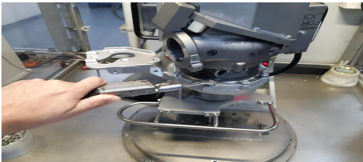
Figura 2 – Aparafusamento realizado manualmente.
