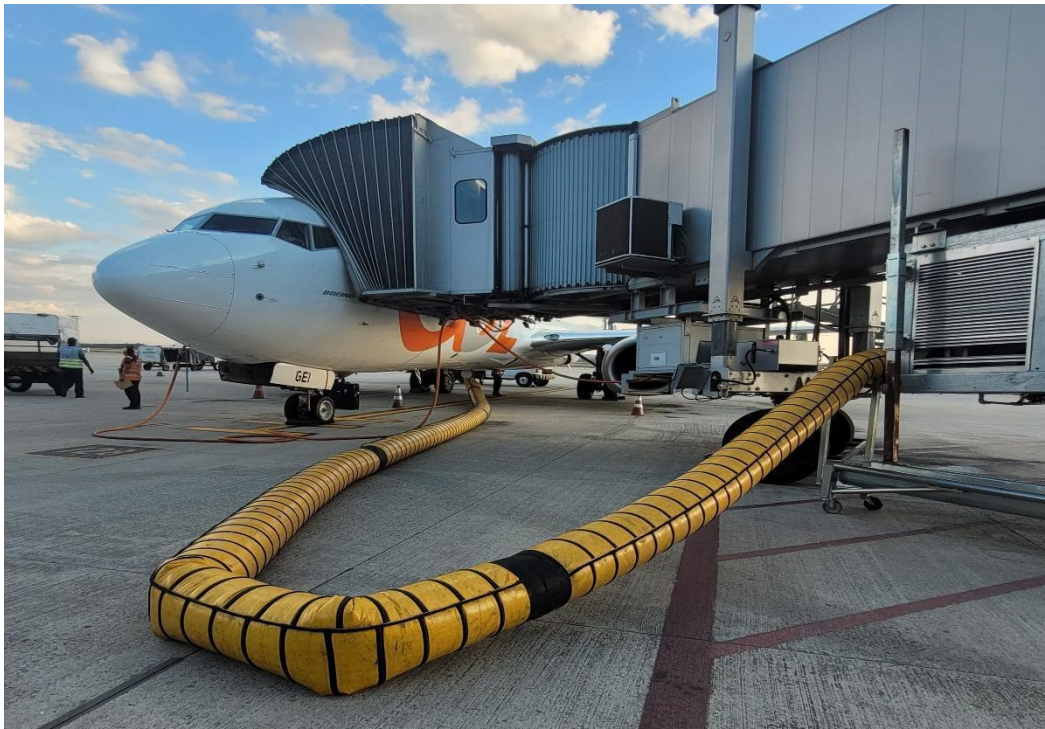
Figura 4: 400Hz + PCA ambos acoplados em aeronave da Gol no Aeroporto Internacional de Confin.
