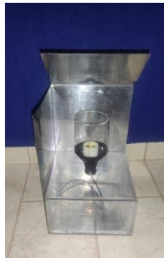
Figura 10 – Estrutura de inox e base de acrílico
